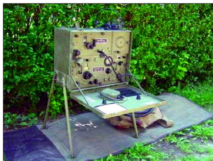
Sl. 5. Radio-uređaj BC-654A postavljen za rad kod YU1RDC
