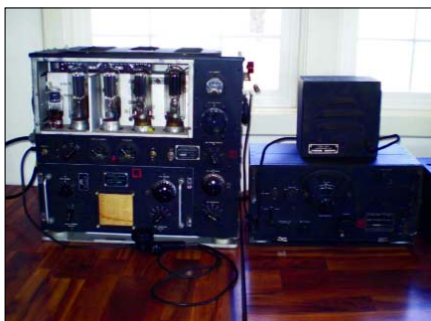
Sl. 6. Predajnik BC-191 i prijemnik BC-348, spremni za rad na amaterskim opsezima
