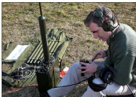
Sl. 11.a. Brana, YT7TU u portablu radi sa svojim uređajem COLLINS 718U-1-9, a koristi originalnu štap antenu od tog uređaja)
